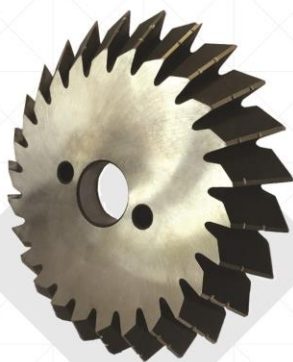
تیغه پخ‌زن یک‌طرفه (HSS Bevel Type) مناسب برای ایجاد BEVEL با زاویه ۳۷٫۵ درجه قابل تیز شدن و تولید در سایزهای ۸ تا ۱۸ اینچ
