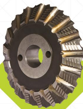
تیغه برش پخ‌زنی دوطرفه همزمان (HSS Compact Type) مقاوم در برابر شکستگی و مناسب جهت برشکاری و پخ‌زنی دوطرفه همزمان لوله‌های تحت تنش مکانیکی خطوط لوله قابل تیز شدن و تولید در سایزهای ۸ تا ۱۸ اینچ
